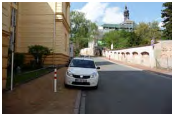
Abb. 8.8: Die vorhandene Gehwegbreite wird teilweise durch Poller und parkende Autos eingeschränkt.
